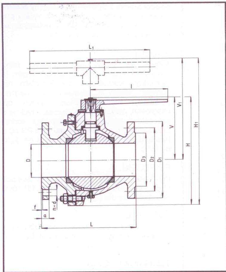
Kohout kulový z ocelolitiny, ovládaný ruční pákou, se vyrábí pro PN 40 a teploty do 80° C jako uzavírací orgán pro neagresivní provozní tekutiny.
