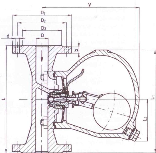
Plovákový odvaděč kondenzátu s automatickým odvzdušňováním, přírubový, z ocelolitiny, pro vodní páru nebo kondenzát z vodní páry.
